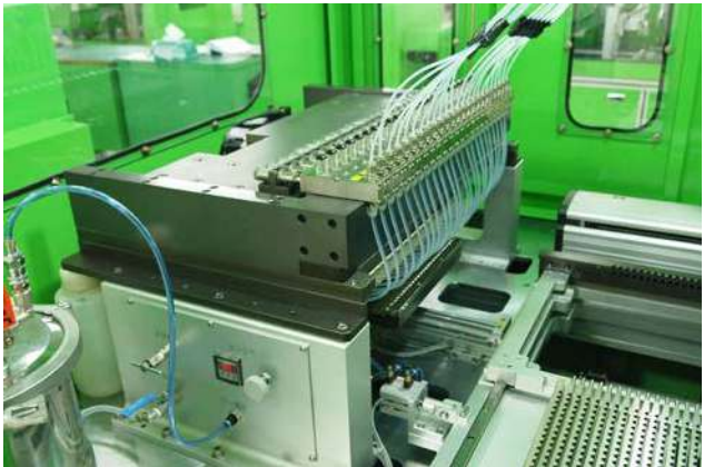
〈 24-ARRAY PLUNGER PUMP SYSTEM 〉
