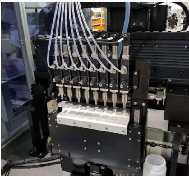
〈 8-process Plunger Pump system 〉
