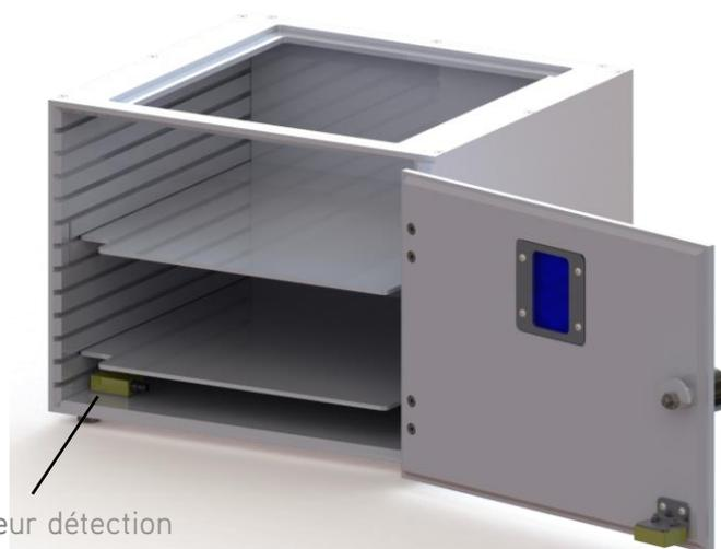
Capteur détection d'ouverture
