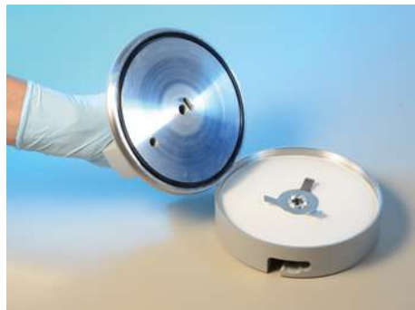
Montage du couvercle du réservoir sous pression
